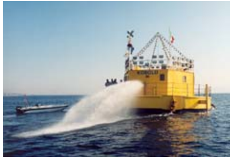
Fig. 3 – La turbina KOBOLD azionante una pompa idraulica (25 kW)
