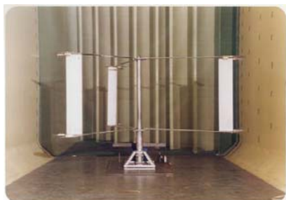
Fig. 1 – Modello di turbina ad asse verticale in galleria del vento presso il DPA
