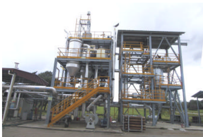
Figura 6: Impianto pilota della Trisaia – sezioni di gassificazione e purificazione a caldo del gas.
